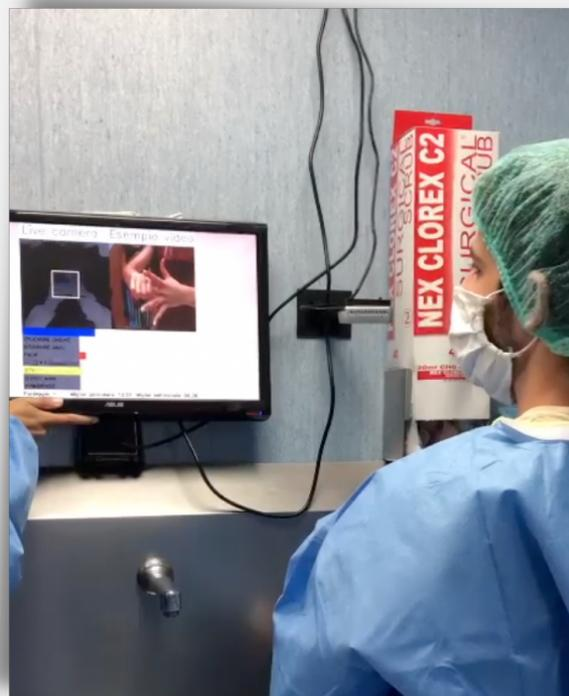
[Sistema di visione artificiale per la verifica in tempo reale della corretta esecuzione del lavaggio preoperatorio delle mani]
